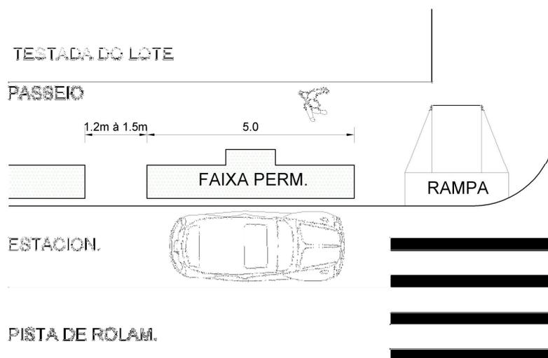
Fig. 04 – Esquema de comprimento da faixa permeável.
