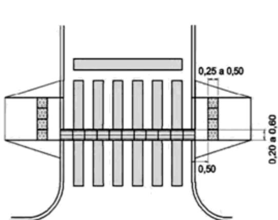
Fig. 08 – Exemplo de rebaixamento de calçada com sinalização tátil e direcional.
