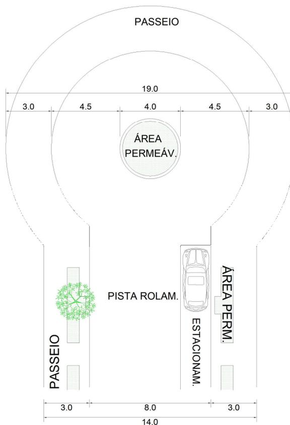
Fig. 01 – Esquema bolsão de retorno.
