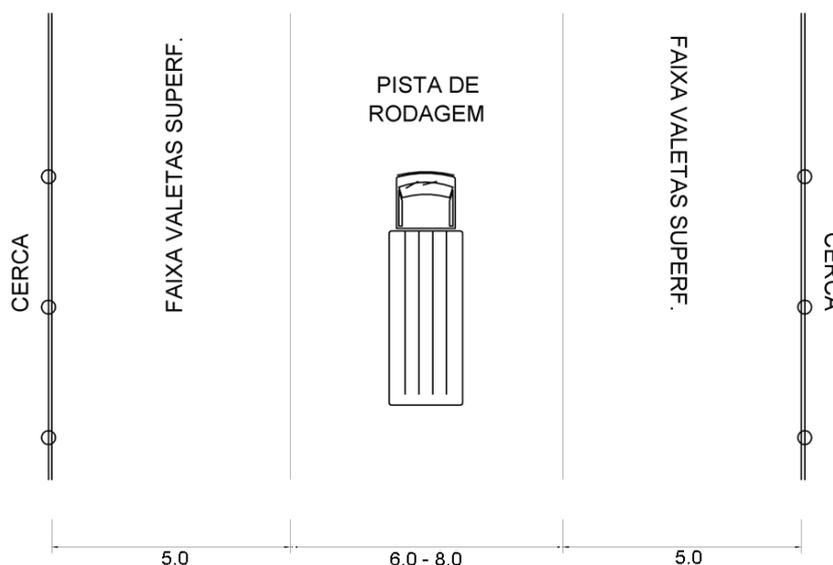
Fig. 11 – Desenho esquemático da conformação das Estradas Secundárias.
