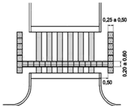
Fig. 09 - Exemplo de rebaixamento de calçada com sinalização tátil e direcional.
